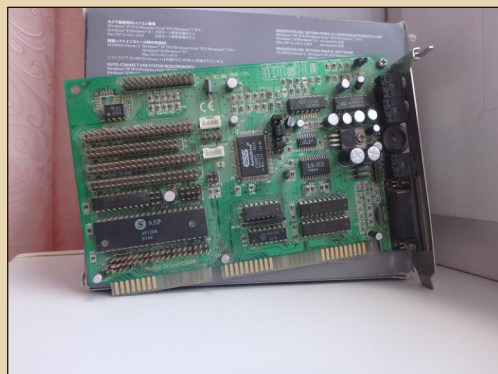
Рис. 6. Miss Melody MF-1115 – на этой карточке уже всё настраивается с помощью перемычек
